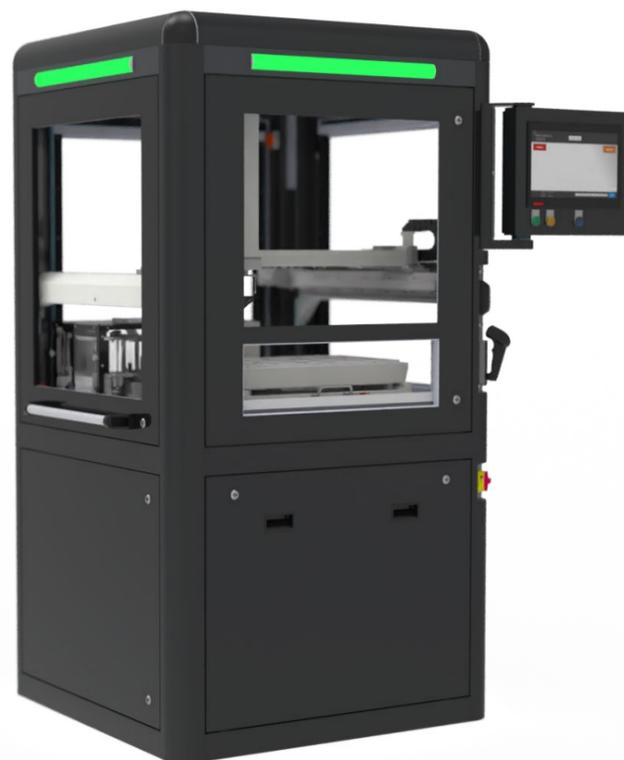
Dimensionics Density est un système de mesure de la densité avancé et automatisé, basé sur le principe d'Archimède. Ce principe permet de déterminer avec précision la densité d'un matériau en mesurant le volume de déplacement d'un liquide. Ce principe classique, a été porté à un niveau supérieur grâce à une technologie de pointe.
