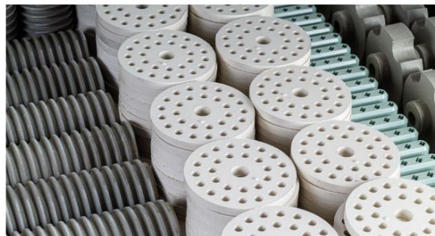
Le DIMENSIONICS DENSITY est capable d'analyser la densité de pièces céramiques crues de différents types. Même les géométries complexes avec de petites ouvertures et contre-dépouilles peuvent être mesurées sans adhérence de bulles, grâce à l'utilisation d'une solution tensioactive spéciale.
