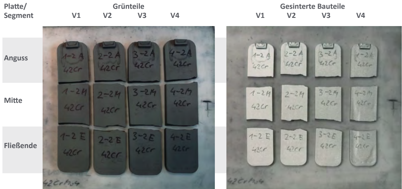
Abbildung 3: Segmentierte Proben V1 ... V4, als Grünteile (links) und im gesinterten Zustand (rechts)
