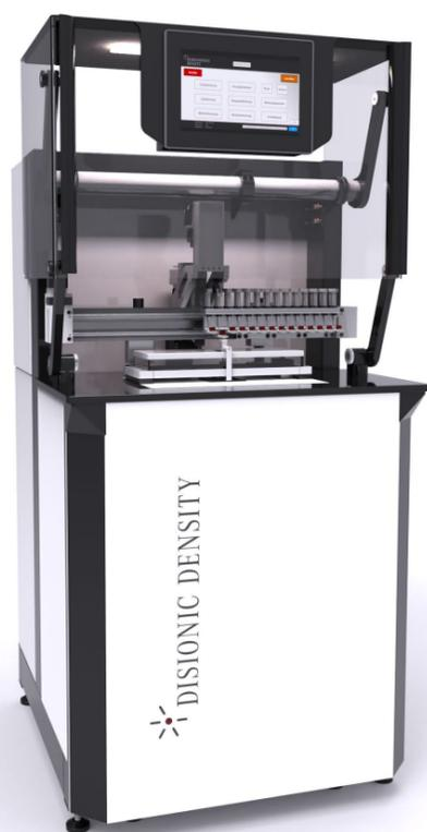
Alle Systeme bedienen sich dabei des archimedischen Prinzips und bieten dank der vollständigen Automatisierung des Prozesses höchste Präzision und eine unerreichte Wiederholgenauigkeit. Ausschließlich die Modellreihe L ist für eine vollständige Automatisierung vorgesehen und bietet den Anwendern somit die Möglichkeit, in einen bestehenden Prozess vollumfänglich inkludiert zu werden. Überzeugen Sie
